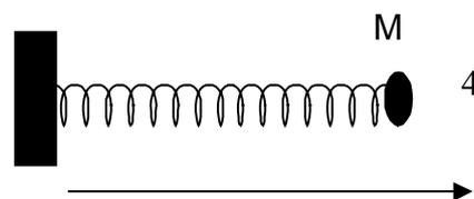
4) Un resorte apoyado horizontalmente sin rozamiento y fijo en un extremo, tiene una masa M sujeta en el otro extremo. Calcule los modos normales de oscilación longitudinal del resorte.
