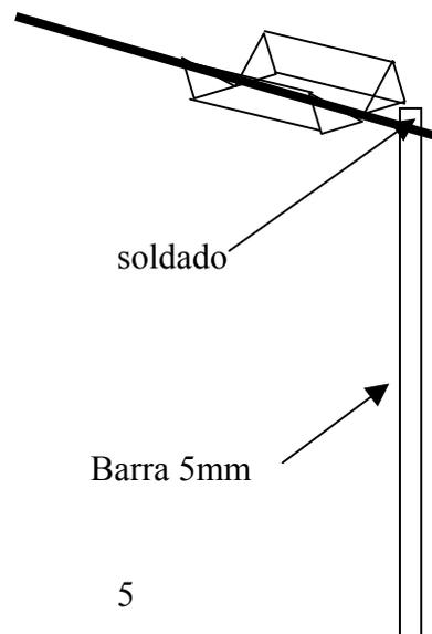
5) Una barra cuelga soldada a un alambre de torsión (similar al caso 2.1) con el otro extremo libre para girar. Encuentre los modos de torsión del alambre. Repita el cálculo para el extremo del alambre fijo.
