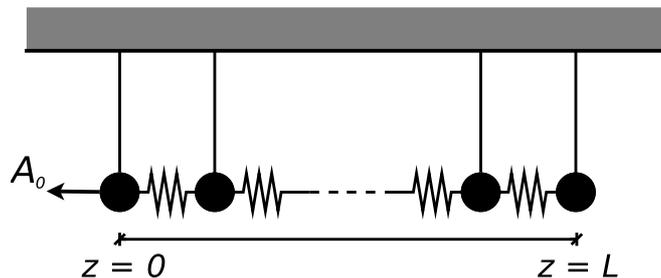
Se aplica una fuerza externa en función del tiempo a la primera masa ( $z = 0$ ), de forma tal que se conoce su amplitud  $\Psi(0, t) = A_0 \cos(\Omega t)$ . Halle el movimiento estacionario del sistema y discuta las hipótesis que hace. Compare con el caso de extremo derecho fijo a una pared (o sea: agregando un resorte a la derecha de la última masa y uniéndolo a la pared).
