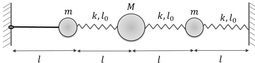
4. Considere el sistema de la figura, en el que se tienen dos partículas de masa  $m$  unidas a las paredes con resortes verticales de longitud natural  $l_0$  ( $l_0 < L/2$ ) y constante  $k_1$ , y con resortes horizontales  $l_0 = 0$  (slinkies) y constante  $k_2$ . Imagine que las partículas tienen la libertad de moverse en el plano y que el sistema es en ausencia de gravedad.
