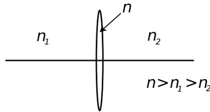
24. a) Determine el radio de curvatura de una lupa equiconvexa ( $n = 1,5$ ) para que su aumento sea 10X. ¿Dónde se encuentra la imagen, y el objeto?
