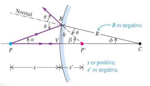
b) Construcción para determinar el aumento de una imagen formada por un espejo convexo
