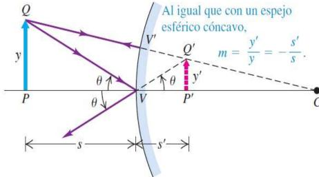
a) Rayos paraxiales que inciden en un espejo esférico convexo divergen a partir de un punto focal virtual
