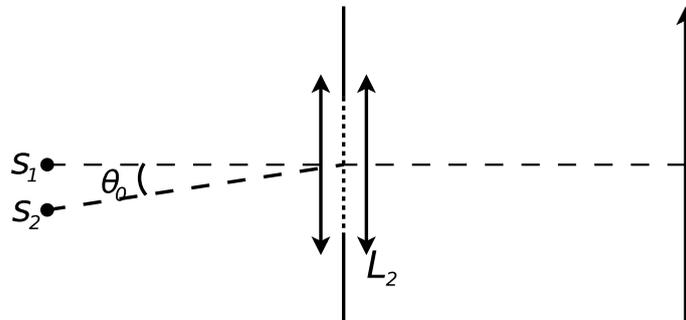
**Datos:**  $\sin(\theta_0) = 0,01$ ; distancia focal de la lente  $L_2 = 3 \text{ m}$ ;  $\lambda_1 = 4000 \text{ Å}$  y  $\lambda_2 = 5000 \text{ Å}$ ;  $a_0 = 0,1 \text{ mm}$ ;  $d_0 = 10 \text{ cm}$ .
