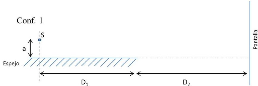
Figura 1: Interferómetro de Lloyd (Configuración 1)
