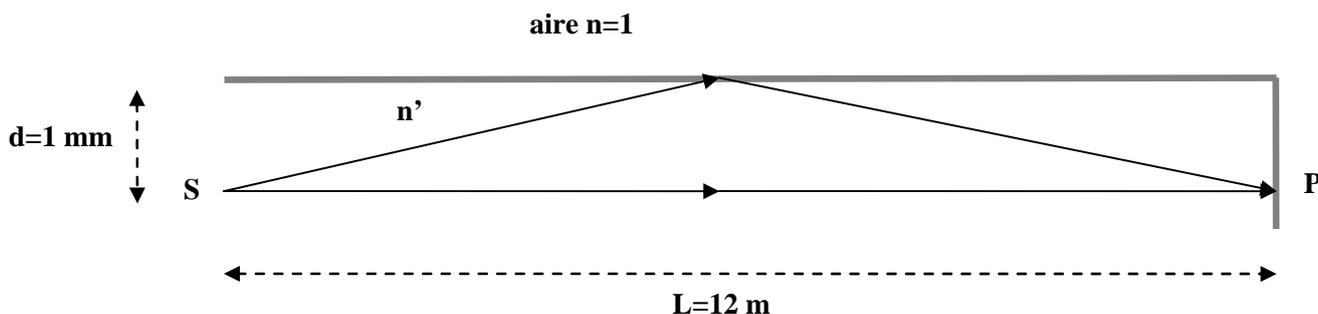
donde  $S$  es una fuente de luz monocromática de  $\lambda = 520 \text{ nm}$ , situada a una distancia de  $12 \text{ m}$  de la pantalla  $P$  y a  $1 \text{ mm}$  de la superficie de separación con el aire.
