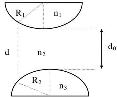
5. Se tiene un dispositivo similar al de la experiencia de Young con modificaciones. Delante de las dos ranuras hay sendos semicilindros de radios  $R_1$  y  $R_2$  de índices  $n_1$  y  $n_2$  respectivamente.
