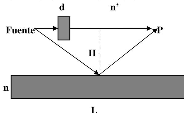
4. Si el dispositivo de **anillos de Newton** se modifica según muestra la figura:
