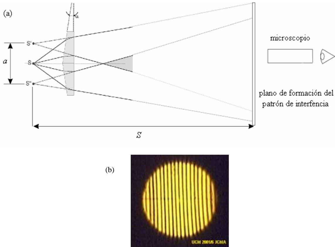
**Figura 1.** Biprisma de Fresnel: (a) La fuente de luz se encuentra en  $s$  y sus imágenes virtuales en  $s'$  y  $s''$  separadas por una distancia  $a$ . Las franjas de interferencia se observan a una distancia  $S$  de las fuentes mediante un microscopio. (b) Patrón de interferencia. Las franjas están separadas a una distancia  $\Delta y$ .
