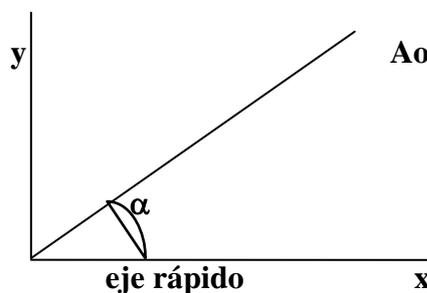
11. Sobre una **lámina birrefringente** inciden dos haces de luz circularmente polarizada de frecuencias  $f_1$  y  $f_2$ , uno en sentido horario y el otro en sentido antihorario. La lámina produce un
