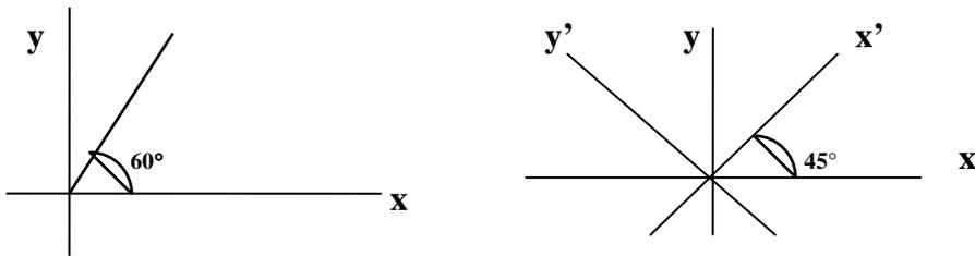
10. Sobre una placa de cuarto de onda inciden dos haces de luz linealmente polarizada y en fase. Uno de ellos incide perpendicularmente polarizado respecto del eje rápido ( $x$ ) y con una amplitud  $E_0$ . El otro haz de amplitud  $A_0$  incide con un ángulo  $\alpha$  respecto del eje  $x$ . Considerando  $E_0$  como dato, halle  $\alpha$  y  $A_0$  para que la luz emergente de la placa esté circularmente polarizada con una amplitud  $2E_0$ .
