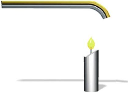
Otro tipo de termómetro común usa *una tira bimetalica*, que se fabrica pegando tiras de dos metales distintos. Al aumentar la temperatura de la tira compuesta, un metal se expande más que el otro y la tira se dobla.
