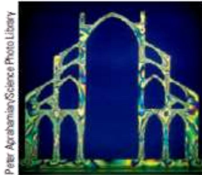
La cantidad de birrefringencia es distinta para longitudes de onda diferentes; de ahí los distintos colores de luz. El color que aparece en cada punto es aquél para el que la luz transmitida está más cerca de estar polarizada a lo largo del eje de polarización del analizador.
