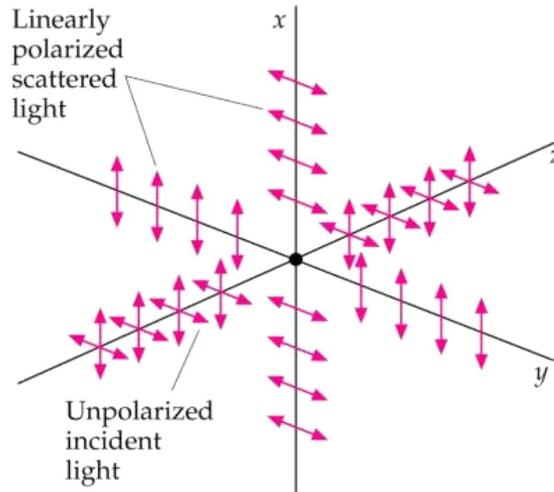
La luz no polarizada que se propaga en una dirección  $z$  incide sobre un centro de dispersión situado en el origen. La luz dispersada en el plano  $z=0$  a lo largo de la dirección  $x$  está polarizada en la dirección  $y$ , mientras que la dispersada en la dirección  $y$  está polarizada en la dirección  $x$ .
