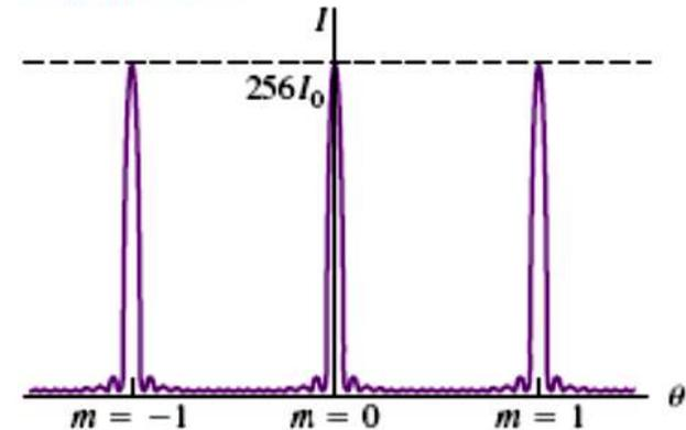
La escala vertical es diferente en cada gráfica;  $I_0$  es la intensidad máxima correspondiente a una sola ranura, y la intensidad máxima con  $N$  ranuras es  $N^2 I_0$
