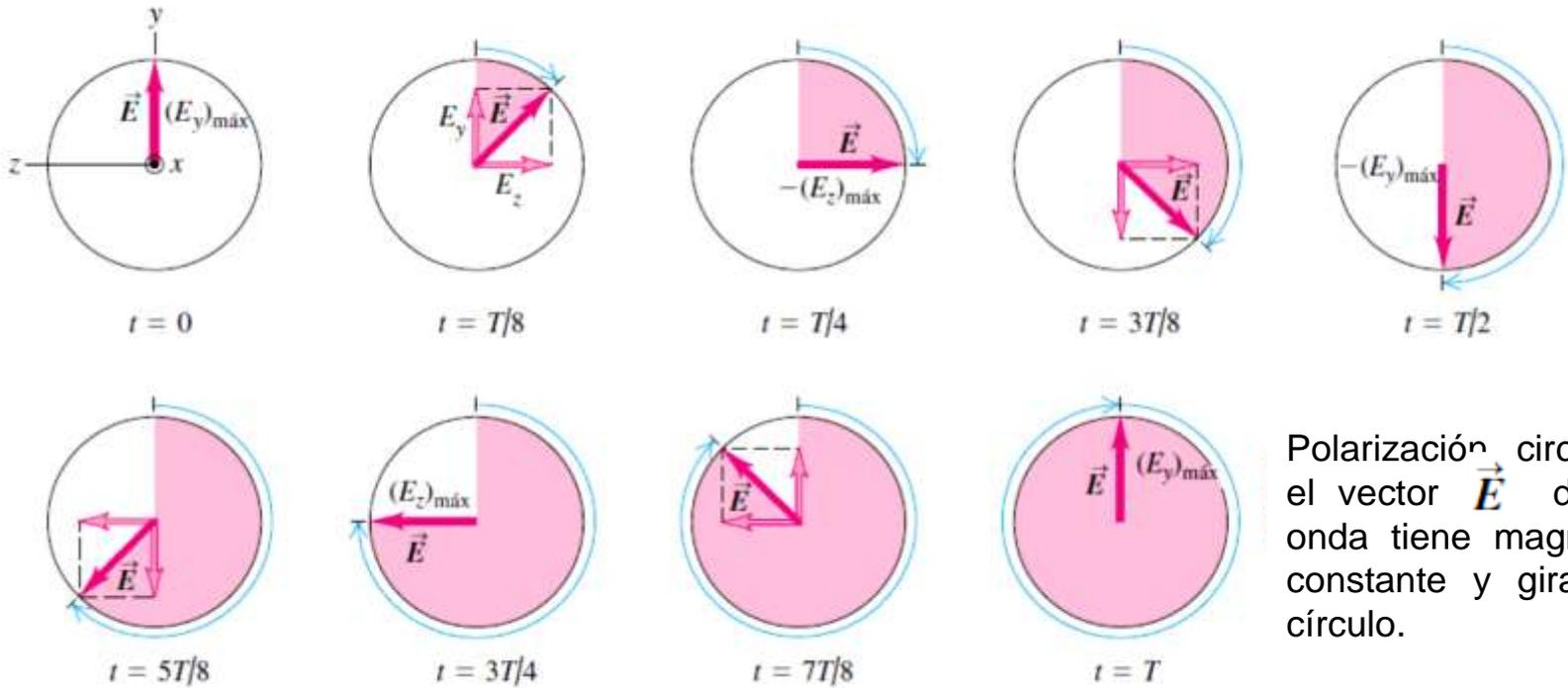
Polarización circular: el vector  $\vec{E}$  de la onda tiene magnitud constante y gira en círculo.
