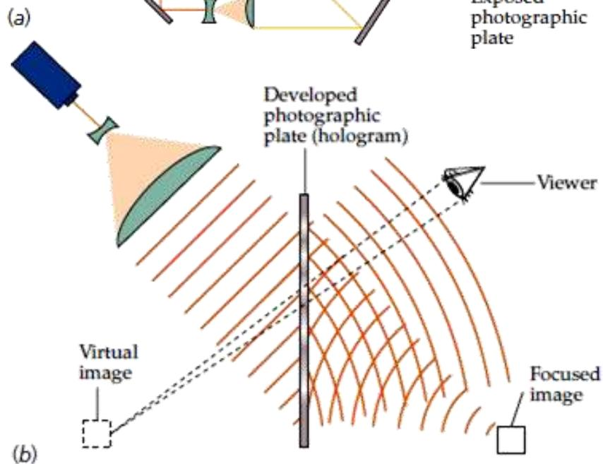
El diagrama de interferencia producido por el haz de referencia y el haz procedente del objeto se registra sobre una película fotográfica.
