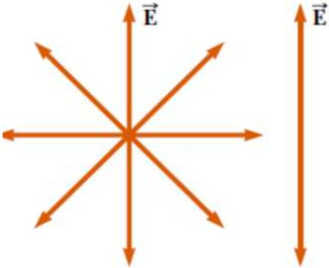
▪ **luz no polarizada** o *luz natural*, luz emitida es una mezcla aleatoria de ondas linealmente polarizadas en todas las direcciones transversales posibles
