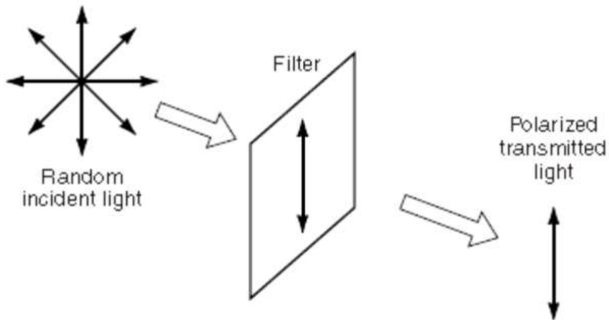
La intensidad de la luz transmitida a través de dos polarizadores depende de la orientación relativa de sus ejes de transmisión.
