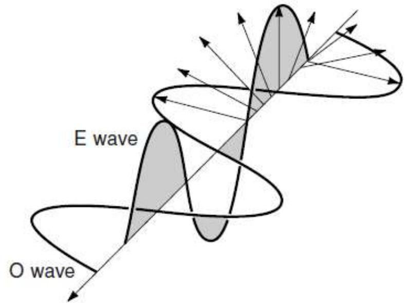
Polarización circular de una onda electromagnética que se desplaza paralelamente al eje  $x$ . La componente  $y$  de  $\vec{E}$  se retrasa un cuarto de ciclo con respecto a la componente  $z$ . Esta diferencia de fase da por resultado una polarización circular por la derecha.
