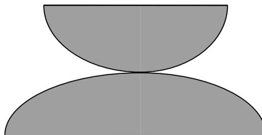
**16.** Se observan anillos de Newton por transmisión que se forman por la interferencia de un haz de luz monocromática de  $\lambda_0 = 4500 \text{ \AA}$  que incide normalmente sobre el dispositivo que se indica en la figura. Datos:  $a = 1,5 \text{ mm}$  ;  $n = 1,5$ .
