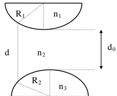
15. Se observan por reflexión los **anillos de Newton** que se forman por la interferencia de los rayos de un haz de luz de  $\lambda = 500\text{ nm}$  que incide normalmente sobre dos superficies esféricas. Si el radio del décimo anillo oscuro es de  $1/3\text{ mm}$  y el radio de curvatura de una de las superficies es de  $50\text{ cm}$ , ¿cuál es el radio de curvatura de la otra superficie?
