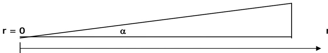
11. Un haz de rayos paralelos de luz amarilla  $\lambda = 590$  nm incide normalmente sobre la superficie plana de una lente plano-convexa, cuya superficie convexa está en contacto con una superficie plana (**dispositivo de Newton**). El radio de curvatura de la lente es de 50 cm, el índice de la lente es  $n_1$ , el de la superficie plana es  $n_3$  y el del medio  $n_2$ , intermedio entre los dos anteriores.
