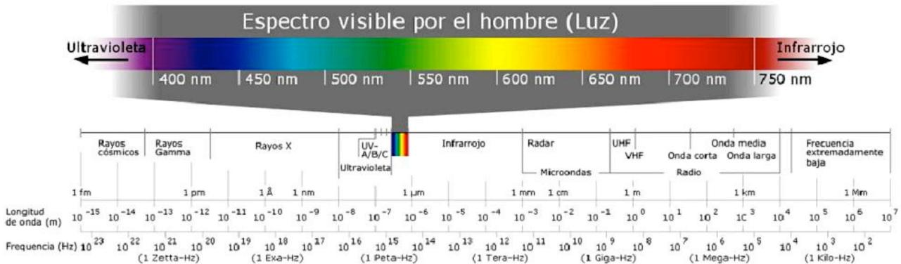
Espectro de las ondas electromagnéticas ( $\lambda$  correspondiente al vacío)
