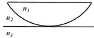
**12.** Con un **dispositivo de Newton** como el de la figura se observan anillos por reflexión. Datos:  $R=1\text{m}$ ;  $d=0.0013\text{ mm}$ ;  $\lambda = 500\text{ nm}$ ;  $n_1=1.5$ ;  $n_2=1.3$ ;  $n_3=1.4$
