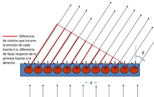
Nos va a interesar analizar el patron generado **muy lejos** de las fuentes... Por ejemplo, aquel que se forma en el infinito (condición de difracción de **Franhauffer**). En otras palabras quiero caracterizar la **emisión en una dirección dada**.
