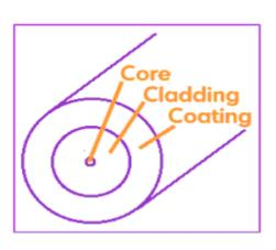
Estructura de una fibra óptica
