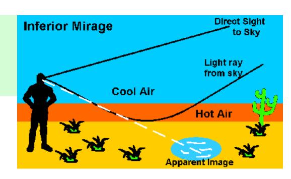
El asfalto de la ruta calienta el aire que está en contacto con él. La luz que viene del cielo se va refractando al ir atravesando capas de aire de mayor T (y menor n). En algún momento hay una reflexión total y al que mira le da la sensación de que hay un espejo de agua que refleja al cielo.
