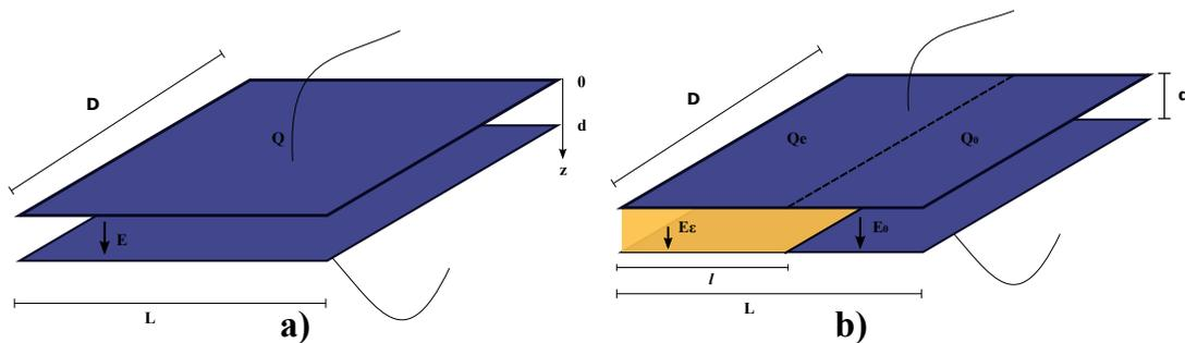
Empecemos por el campo eléctrico que se genera dentro de un capacitor de placas paralelas con ningún medio entre ellas, que se carga hasta obtener una carga  $Q$ . Podemos hacer la aproximación de utilizar el valor del campo del caso en que las placas tienen extensión infinita, lo cual es una buena aproximación dentro del capacitor, fallando sobre todo en los bordes. Haciendo esto, el campo resulta ser
