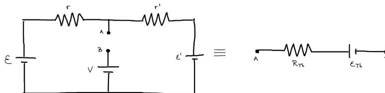
La fem de Thévenin  $\mathcal{E}_{Th}$  es la diferencia de potencial entre  $A$  y  $B$  sin conectar a nada. En este caso el circuito tiene una sola malla. Llamemos  $i$  a la corriente que circula por él en el sentido de las agujas del reloj:
