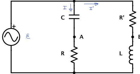
Denotaremos las corrientes y las caídas de potencial complejas con una tilde ( $\tilde{\phantom{x}}$ ). Así, por ejemplo, la corriente compleja correspondiente a  $I$  es  $\tilde{I}$ . Aplicando la ley de Ohm a la rama de  $A$  y a la rama de  $B$  obtenemos
