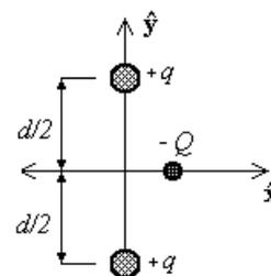
coordenadas  $(x,0)$ , a igual distancia de ambas cargas  $+q$ . Muestre que si  $x$  es pequeña en relación con  $d$ , el movimiento de  $-Q$  es armónico simple a lo largo de la recta que equidista de ambas cargas  $+q$  y determine el período de ese movimiento.
