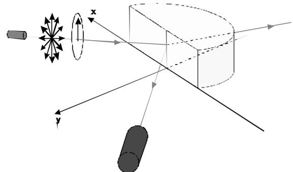
**Figura 2.** Esquema experimental propuesto para el estudio de la polarización por reflexión.
