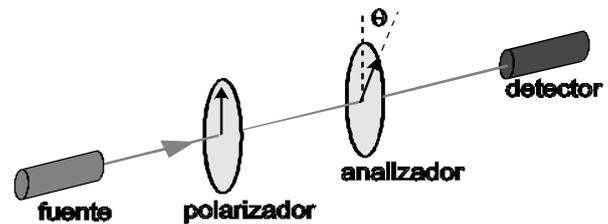
**Figura 1.** Esquema experimental propuesto para el estudio de la ley de Malus.
