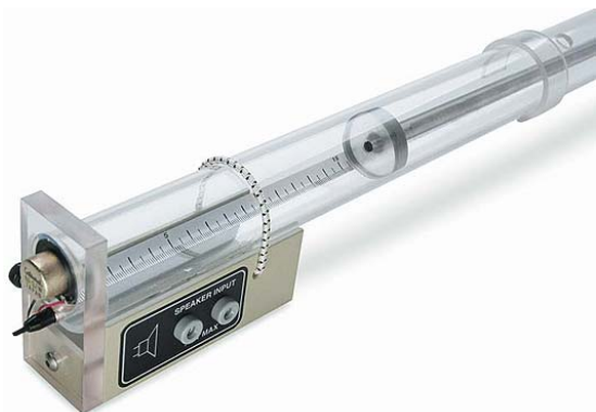
Figura 1. Tubo de Kundt del fabricante Pasco utilizado en el laboratorio de ondas del DF.
