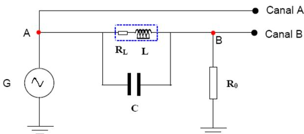
Figura 2. Esquema del circuito RLC paralelo.
