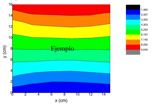
En las esquinas del gráfico se puede visualizar además una tendencia a curvarse hacia las placas. Esto se debe a que, hacia los extremos de las placas, ya no vale la aproximación de plano infinito por lo tanto el campo se deforma.
