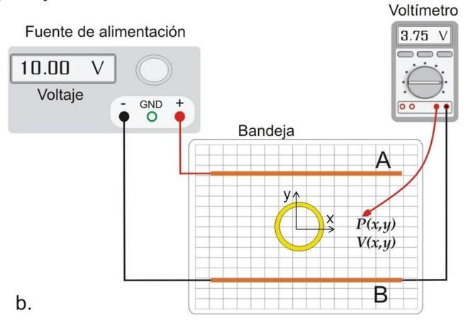
**Observación:** Una aplicación de la cuba electrostática es la electroforesis (técnica para separación de moléculas)
