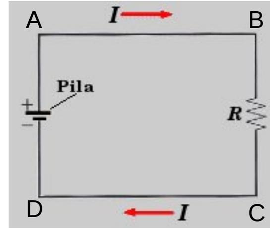
2<sup>da</sup> Ley de Kirchhoff: la suma algebraica de las diferencias de potencial en un circuito cerrado es cero. Es decir, que  $0 = V_{AA} = V_{BA} + V_{CB} + V_{DC} + V_{AD} = 0 - I * R + 0 + \text{fem} \rightarrow$
