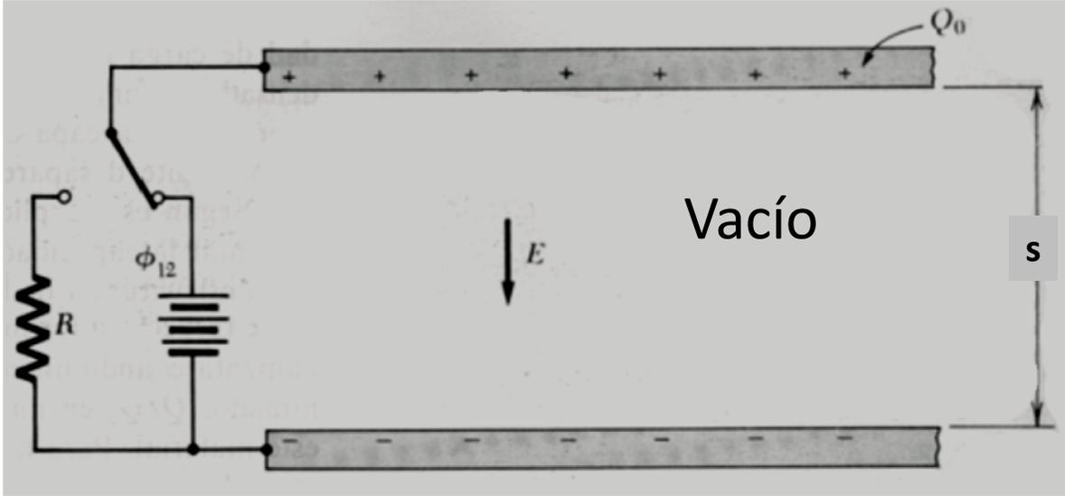
La batería mantiene la diferencia de potencial  $\phi_{12}$ . Con una carga  $Q_0$ , tenemos:
