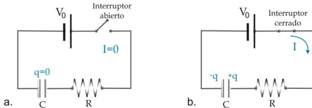
**Figura 1.** a. Capacitor descargado al inicio; b. Carga del capacitor. Cuando el interruptor se cierra ( $t = 0$ ), la corriente pasa de cero a  $V_0/R$ . A medida que transcurre el tiempo,  $q$  tiende a la carga final  $Q$ , y la corriente  $I$  disminuye tendiendo a cero.
