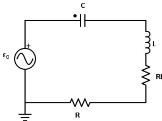
Figura 4. Esquema de un circuito RLC en serie.
