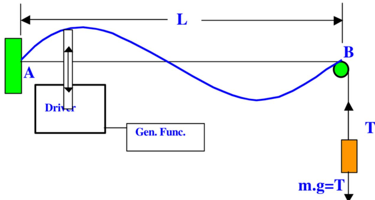
1) Encontrar los modos normales de una cuerda variando la frecuencia del forzado. Registrar la frecuencia. Pensar como estimar el error de la frecuencia.
