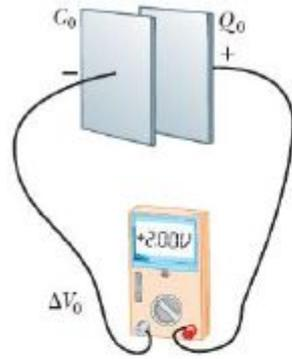
Capacitor con carga inicial  $Q_0$  y capacidad  $C_0$
