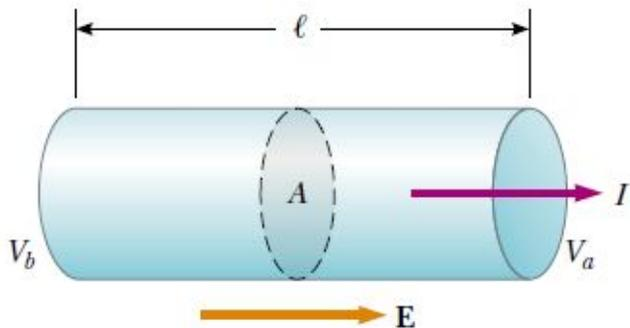
Aplicamos una diferencia de potencial en los extremos de un conductor.
