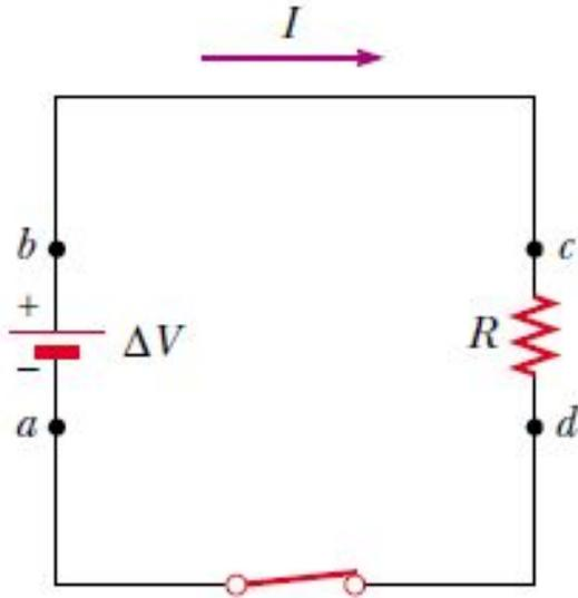
La batería transforma energía química en energía eléctrica, entrega energía eléctrica al circuito.
