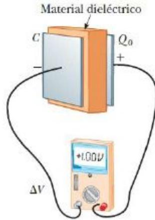
Se verifica experimentalmente que la diferencia de potencial entre las placas disminuye.
