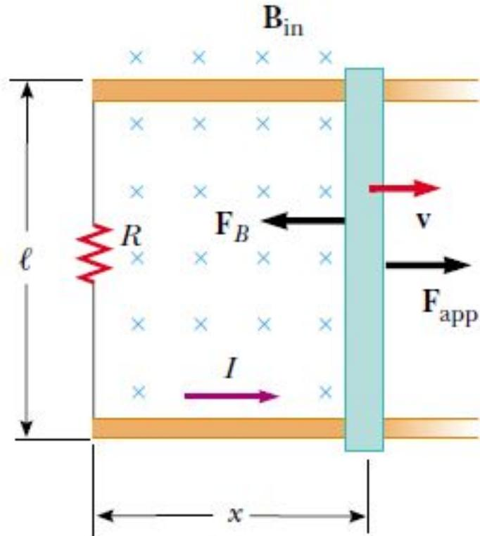
Para el ejemplo de la barra que desliza, la **corriente** que se induce **circula en sentido antihorario**.
