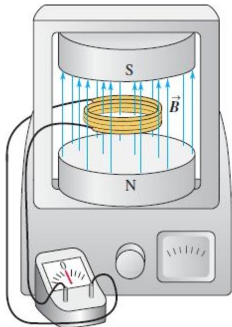
1. Cuando no hay corriente en el electroimán, por lo que  $\vec{B} = 0$ , el galvanómetro no indica corriente.
