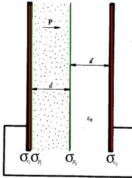
El campo en el interior de las placas es entonces la suma de los campos producidos por estos cuatro planos de carga. Utilizando la expresión para el campo generado por un plano infinito de carga homogénea, obtengo que
