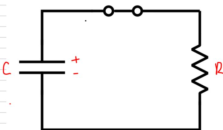
Eventualmente toda la energía que almacenaba el capacitor la disipa la resistencia y el sistema queda con  $Q = 0$  e  $I = 0$
