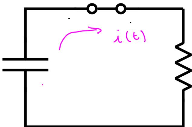
$$i(t) = -\frac{dq}{dt} = \frac{Q}{RC} e^{-t/RC} \quad i(t) \xrightarrow[t \rightarrow \infty]{} 0$$
