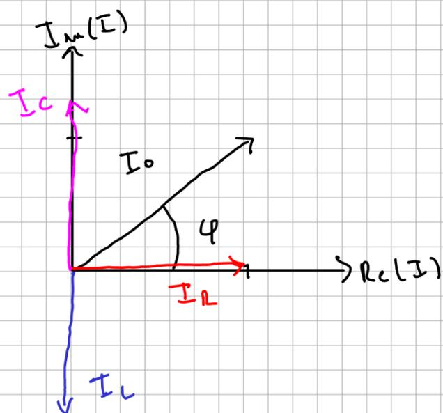
$$\varphi = \arctan \left[ \frac{\text{Im}(I_0)}{\text{Re}(I_0)} \right]$$
