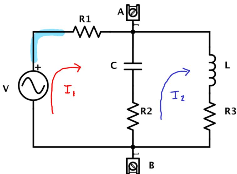
$$\begin{cases} V_0 - I_1 z_R - I_1 z_C - I_1 z_R + I_2 z_C + I_2 z_R = 0 \\ -z_R I_2 - z_C I_1 + z_R I_1 + z_C I_1 - z_C I_2 - z_R I_2 = 0 \end{cases}$$
