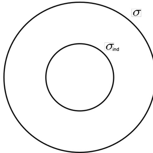
El potencial total se obtiene entonces como una suma de los potenciales debidos a dos cascarones esféricos de densidad de carga constante: el potencial debido a  $\sigma$  ubicada en  $r = b$  más el potencial debido a  $\sigma_{\text{ind}}$  ubicada en  $r = a$ ,
