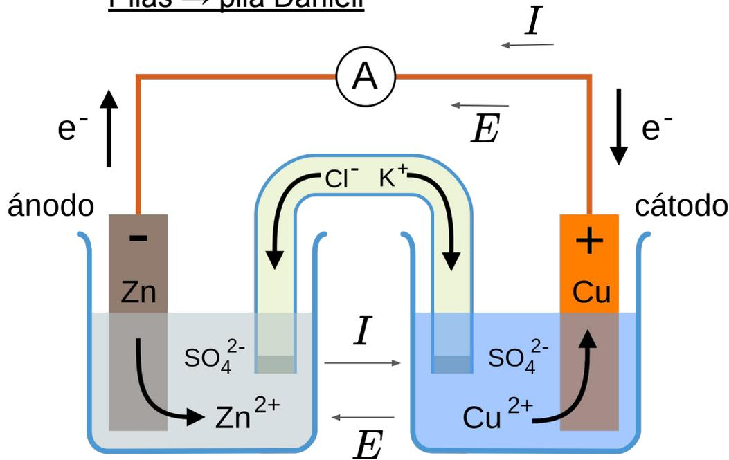
Se genera una diferencia de potencial con una reacción química → en el **ánodo** (el borne negativo de la pila) ocurre una reacción llamada **oxidación** ( $\text{Zn}_{(s)} \rightarrow \text{Zn}^{2+}_{(aq)} + 2e^-$ ), mientras que en el **cátodo** (el borne positivo de la pila) ocurre una reacción llamada **reducción** ( $\text{Cu}^{2+}_{(aq)} + 2e^- \rightarrow \text{Cu}_{(s)}$ ).
