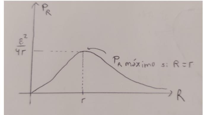
Si cortocircuitamos la batería ( $R=0$ ) vemos que la corriente que circula es máxima  $I_{max} = \varepsilon/r$  y la potencia se disipa toda en la batería  $P = \frac{\varepsilon^2}{r}$  y la batería se puede recalentar  $\rightarrow$  ojo !
