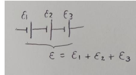
Así se hace por ejemplo en una batería de auto (hechas con plomo, óxido de plomo y ácido sulfúrico)
