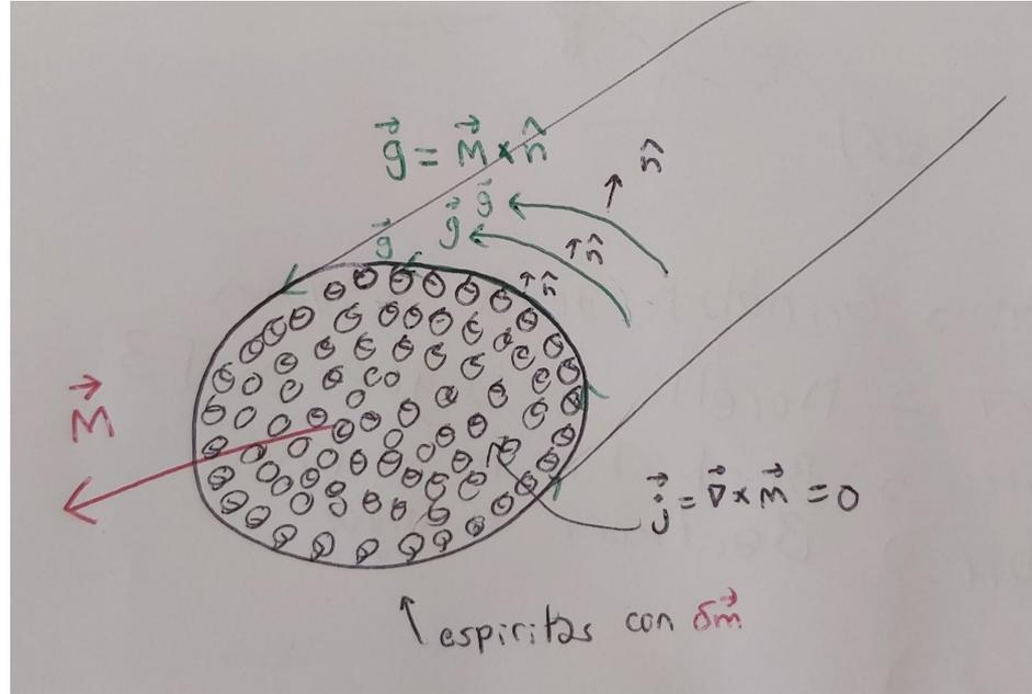
Un cilindro con magnetización  $\vec{M}$  uniforme en la dirección de su eje tiene una corriente de magnetización  $\vec{g}$  en su cara lateral en la dirección azimutal, que podemos interpretar como la superposición de las corrientes de muchas espiritas con momento magnético en la dirección del eje del cilindro.
