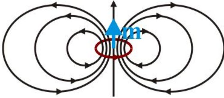
campo magnético de un dipolo magnético  $\vec{m}$
