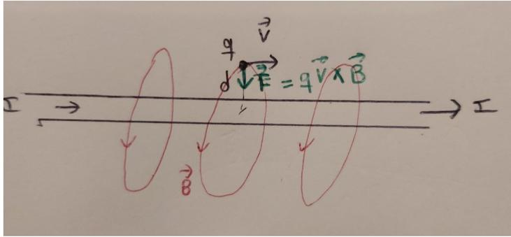
Como la corriente en el cable genera un campo magnético, sobre la carga en movimiento actúa la fuerza magnética de Lorentz,  $\vec{F} = q(\vec{v} \times \vec{B})$ , que hace que la carga se desvíe y se acerque al cable.
