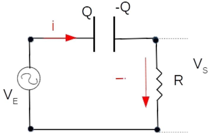
A frecuencias altas el condensador no opone resistencia (actúa como un cable).
