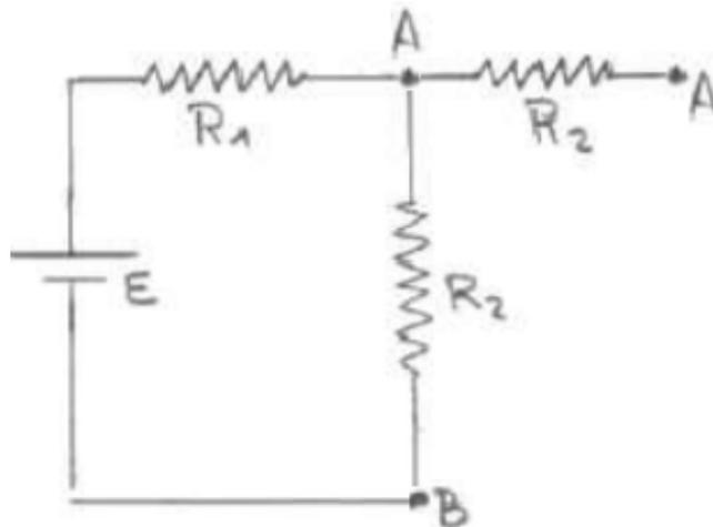
Al no estar esa resistencia conectada a nada, no circula corriente por ahí. Entonces puedo mover el punto A como lo hice.
