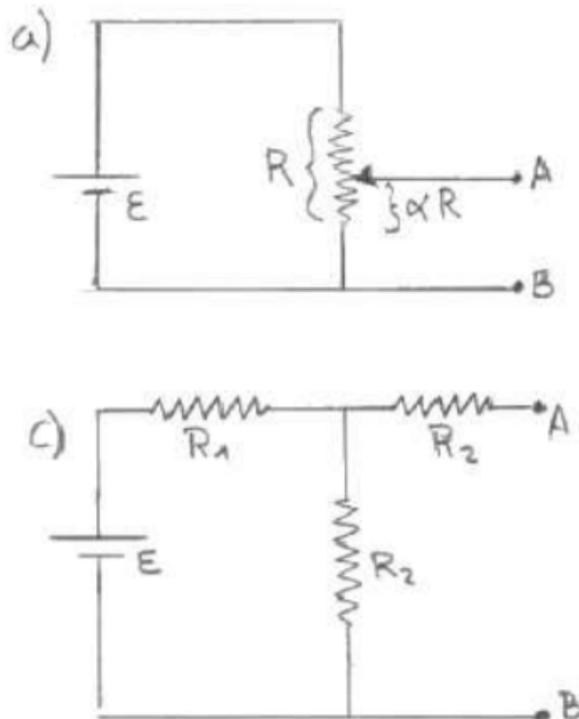
a) Podemos descomponer la resistencia  $R$  en dos resistencias en serie de valores  $\alpha R$  y  $(1-\alpha)R$  tal que la suma da  $R$ . Lo redibujamos:
