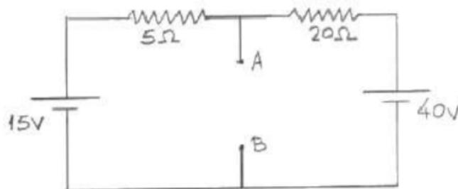
La fuente de Thevenin se calcula como la diferencia de potencial entre A y B:  $V_{TH} = V_A - V_B$
