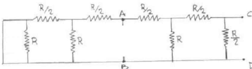
Para obtener  $V_{TH}$  saco la carga entre A y B y calculo la diferencia de potencial entre ambos puntos.
