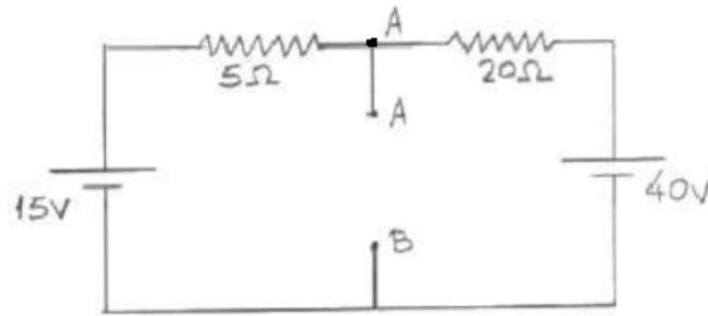
Para llegar a A puedo salir de la batería de 15 V y pasar por la resistencia de 5 Ω. O sea que  $V_A = 15V - 5\Omega \cdot I$ .
