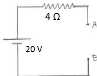
En los puntos siguientes nos proponen poner distintas resistencias  $R_i$  entre A y B, y calcular la potencia disipada en ellas.
