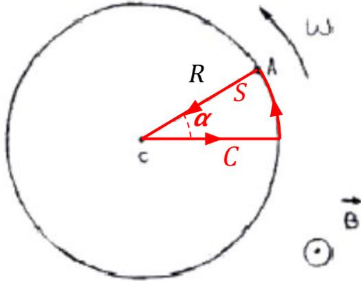
Otro posible formato de dínamo, tenemos un disco conductor de radio  $R$  perpendicular a un campo magnético  $B$  constante que gira con velocidad angular  $\omega$  respecto de su eje. Queremos la fem entre  $A$  y  $C$ . Prueben hacerlo por Faraday, teniendo en cuenta:
