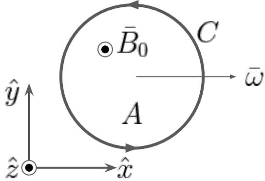
Espira circular girando con velocidad angular  $\omega$  en torno de uno de sus ejes, perpendicular a un campo magnético uniforme. Queremos la fem inducida sobre ella. Suponemos que a  $t=0$  está ortogonal al campo y tomamos un sentido de circulación antihorario (con normal paralela a  $\mathbf{B}$ ). ¿Cómo es el flujo en función de  $t$ ?
