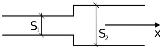
onda acústica de la forma  $\delta P_0(x, t) = A_0 \cos(\omega t - k_1 x)$  incide desde el primer tubo hacia  $x > 0$ . Hallar las amplitudes de presión y desplazamiento de las ondas reflejadas y transmitidas.
