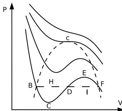
El punto  $c$  es el punto crítico del gas. Las isothermas continuas dentro de la campana corresponden a vapor sobresaturado, las punteadas corresponden a la línea de equilibrio líquido-vapor.
