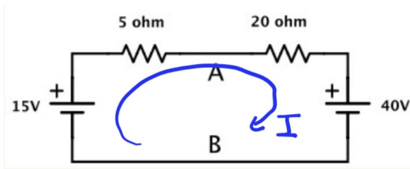
Como el circuito tiene una sola malla es fácil ver que la corriente que circula se puede calcular a partir de la siguiente ecuación:
