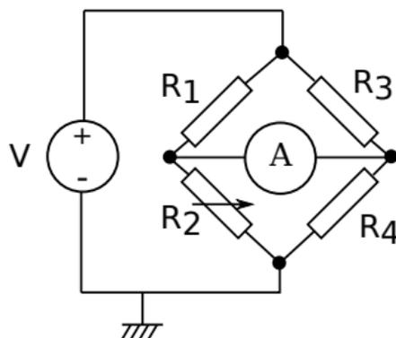
La resistencia  $R_2$  es variable,  $R_1$  y  $R_3$  son conocidas y queremos saber  $R_4$ . La idea es ajustar el valor de  $R_2$  hasta que no circule corriente entre los puntos  $C$  y  $D$  (es decir, no hay diferencia de potencial entre esos puntos) y eso ocurre cuando se cumple
