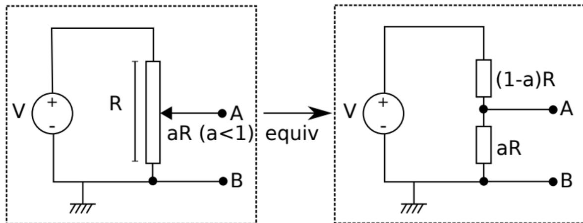
Notar que en el circuito de la derecha la resistencia  $aR$  es la resistencia de carga. A este tipo de circuito se lo denomina potenciómetro. Noten que variando el valor de  $a$  se pueden obtener distintos voltajes de salida, desde  $V_{\text{out}} = 0$  para  $a = 0$  hasta  $V_{\text{out}} = V$  para  $a = 1$ .
