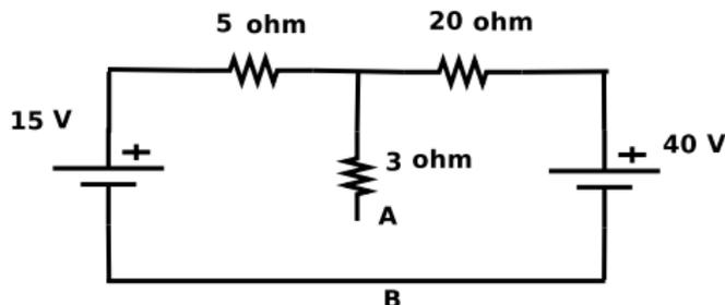
En este caso, como tenemos que calcular la  $V_{AB}^{eq}$  a circuito abierto, NO circula corriente por la resistencia de  $3\Omega$  y por lo tanto la  $V_{AB}^{eq}$  es la misma que en el caso del circuito anterior. No así la  $R_{eq}$ , que se calcula de la siguiente manera:
