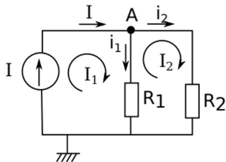
FIGURA: El círculo con una flecha representa una fuente de corriente
