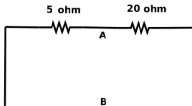
Se puede ver que la resistencia de  $5\Omega$  está en paralelo con la resistencia de  $20\Omega$ :
