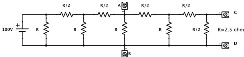
Para calcular el equivalente de Thevenin entre A y B, sacamos la resistencia que se encuentra entre A y B y calculamos  $R_{AB}^{th}$ . Para ello es necesario cortocircuitar la fuente (los detalles de este cálculo lo dejo como tarea)
