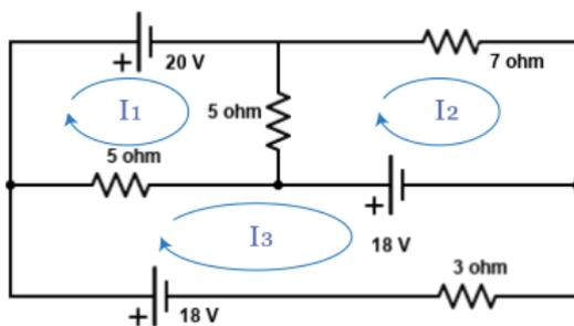
Si se coloca un amperímetro en serie con la batería de 20V y la resistencia del mismo es  $1\Omega$ , la ecuaciones serán:
