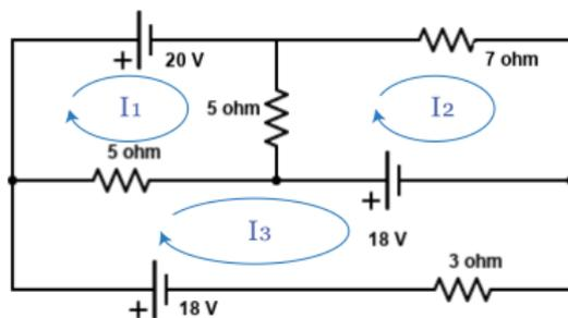
Si el amperímetro está en serie con la resistencia de  $3\Omega$ , la ecuaciones serán:
