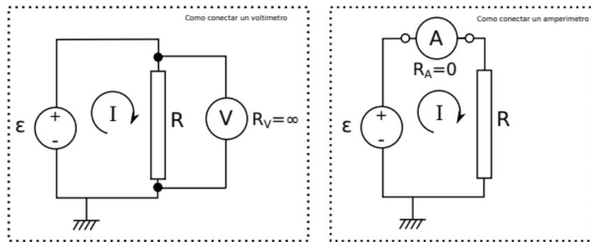
El voltímetro se conecta en paralelo a la caída de tensión que se desea medir y debe ser a **circuito abierto** (la corriente que circula a través del voltímetro debe ser despreciable  $R_{\text{voltímetro}} \simeq \infty$ ).
