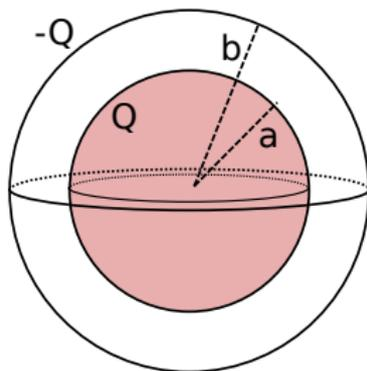
Para este problema nos interesa saber el campo eléctrico entre las esferas. Esto puede obtenerse utilizando la ley de Gauss o superposición.
