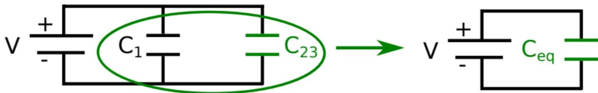
Mirando fijamente un poco menos notamos que  $C_1$  y  $C_{32}$  están en paralelo y la capacidad equivalente es
