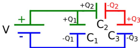
Recordemos que cada conductor es un equipotencial. El conductor **azul** está a potencial  $V$ , el **verde** a  $V = 0$  y el **rojo** a  $V' \neq V$  (aunque no nos piden averiguar el valor de  $V'$ ).
