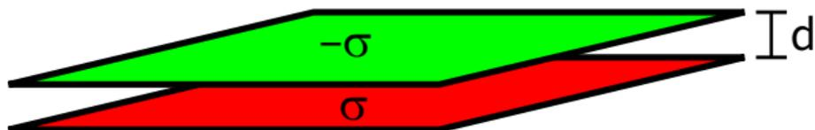
El campo eléctrico de esta configuración se puede obtener por superposición dos placas infinitas con densidades de carga opuesta.
