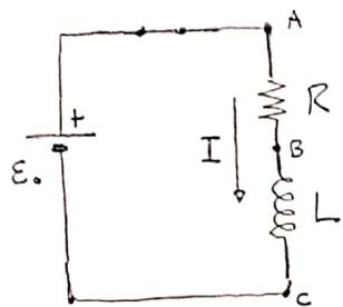
obs: Tanto la batería como la bobina de la inductancia, como los hilos del circuito, tendrán cierta resistencia. Representaremos la suma como una resistencia  $R$  en serie. De igual modo,  $L$  incluya la inductancia (menor) del mismo circuito. Así, el circuito ideal de la figura es una buena representación del circuito físico.
