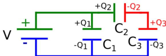
Recordemos que cada conductor es un equipotencial. El conductor **verde** está a potencial  $V$ , el **azul** a  $V = 0$  y el **rojo** a  $V' \neq V$  (aunque no nos piden averiguar el valor de  $V'$ ).
