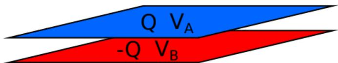
Si tenemos un capacitor formado por dos placas con la placa de arriba a potencial  $V_A$  y la placa de abajo a  $V_B$  donde  $V_A - V_B > 0$ , entonces
