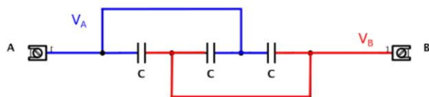
Teniendo esto en cuenta podemos re-dibujar el circuito de la siguiente manera y la capacidad equivalente del circuito sale fácilmente  $C_{eq} = 3C$ .
