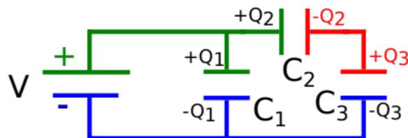
La diferencia de potencial entre la cara verde del capacitor 2 y la cara azul del capacitor 3 también es  $V$ . Notemos además que el conductor rojo está aislado y su carga total es cero, por lo tanto  $-Q_2 + Q_3 = 0$ . Entonces
