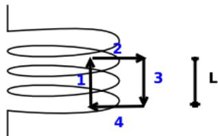
Ahora tomamos una curva que tiene una parte dentro y una parte fuera del solenoide. En este punto, tenemos que asumir que  $\vec{B} = 0$  fuera del solenoide para obtener el valor del campo dentro del solenoide. Esta hipótesis la vamos a
