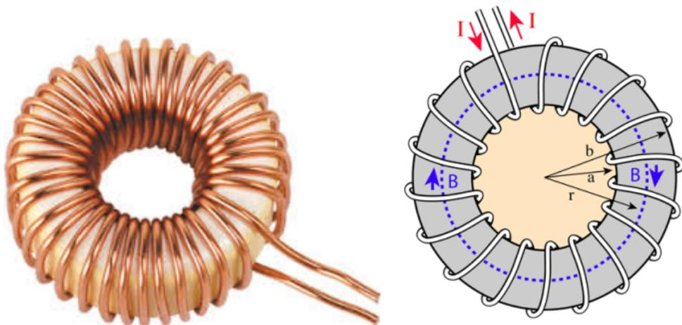
La segunda figura muestra la proyección de un toroide en el plano  $x - y$ . Se puede ver que el toroide tiene simetría de revolución alrededor del eje  $z$  y por lo tanto el campo  $\vec{B}$  no va a depender de la coordenada  $\phi$ .
