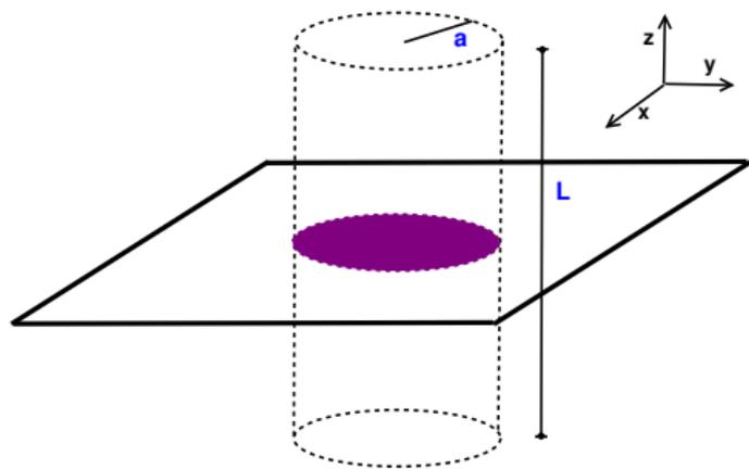
$$\iint \vec{E} \cdot d\vec{S} = \iint_{\text{TAPA}_1} \vec{E} \cdot d\vec{S} + \iint_{\text{TAPA}_2} \vec{E} \cdot d\vec{S} + \iint_{\text{PARED}} \vec{E} \cdot d\vec{S}$$
