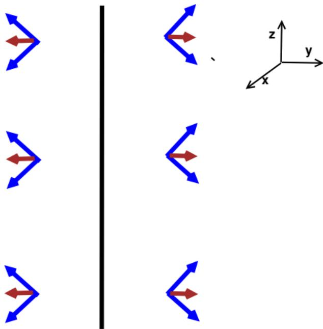
El razonamiento de la figura anterior se puede extender a todos los puntos campo del espacio, algunos se pueden ver en la figura. Por lo tanto el campo eléctrico de un hilo infinito:
