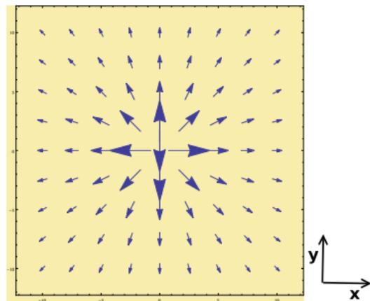
En la figura de la izquierda, se muestra el gráfico del campo eléctrico del hilo en el plano  $xy$ , es decir,  $z = cte$ : un campo con dirección radial y cuya intensidad disminuye con la distancia al centro del hilo.
