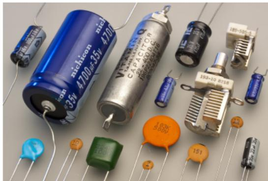
FIGURA: Diferentes tipos de capacitores. Fuente: [WIKIPEDIA](#).
